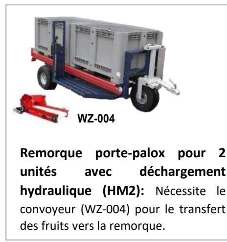
**Remorque porte-palox pour 2 unités avec déchargement hydraulique (HM2):** Nécessite le convoyeur (WZ-004) pour le transfert des fruits vers la remorque.
