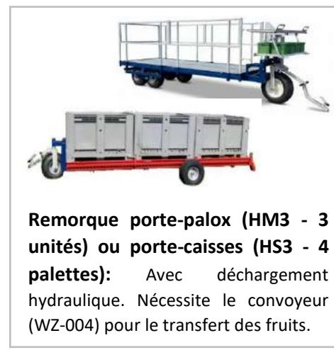
**Remorque porte-palox (HM3 - 3 unités) ou porte-caisses (HS3 - 4 palettes):** Avec déchargement hydraulique. Nécessite le convoyeur (WZ-004) pour le transfert des fruits.
